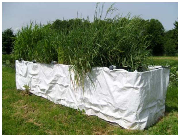
Abb. 9: Mit Folie verkleidete Lysimetervariante im dritten Betriebsjahr im Sommer 2014
