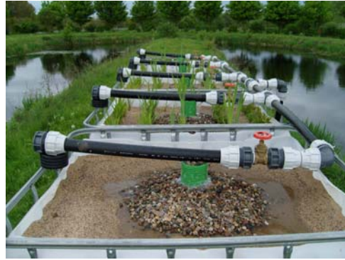
Abbildung 7: Betriebsbereiter Versuchsfilter mit Substraten, Bepflanzung und Beschickungsleitung im Mai 2012
