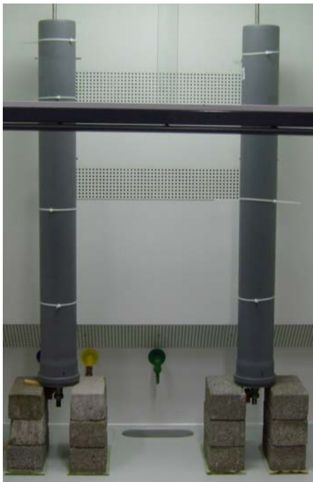
Abbildung 15: kleinskalige Filtersäulen mit einer Höhe von 100 Zentimetern und bodenseitigem Auslasshahn zum Entnehmen der Wasserproben
