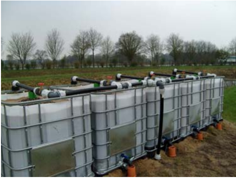
Abbildung 6: Lysimeteranlage mit Beschickungs- und Ablaufsystem im März 2012
